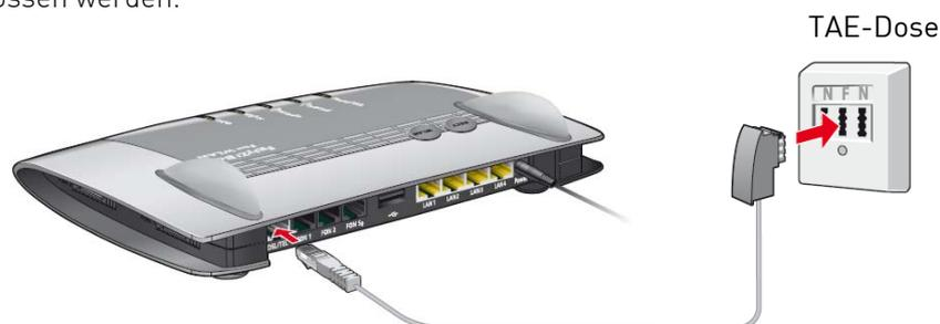
Verbindung mit dem DSL Anschluss herstellen
